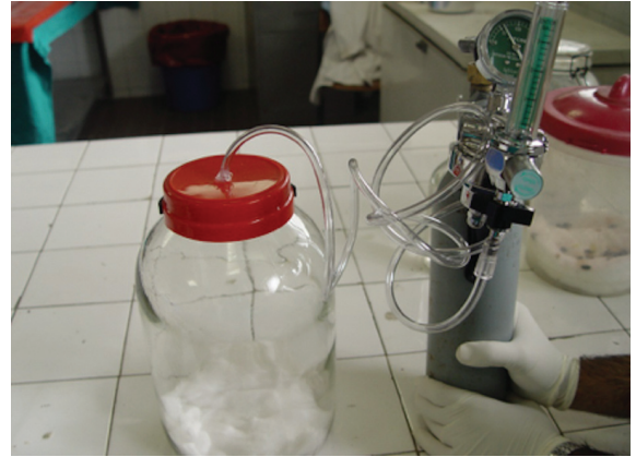
Resim 1. Hipoksi oluşturmak için kullanılan hava sızdırmaz düzenek.
